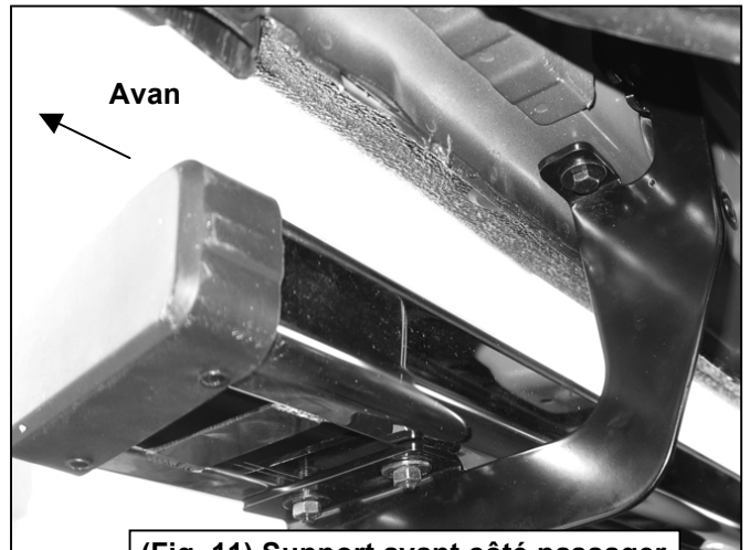
(Fig. 11) Support avant côté passager fixé au marche pied
